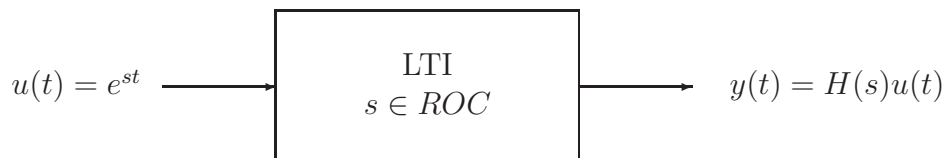
FIG. 8.1 – La propriété de transfert d'un système LTI (valable dans le domaine de convergence de H ).
