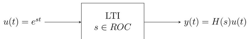
FIGURE 8.1 – La propriété de transfert d'un système LTI (valable dans le domaine de convergence de  $H$ ).
