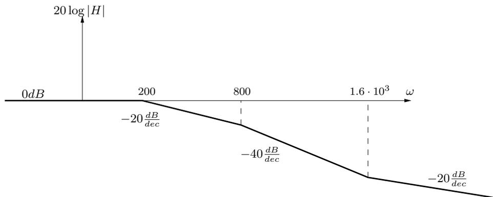
**Exercice 140** - *Septembre 2000* - On désire réaliser un compensateur de manière à ce que la réponse fréquentielle du système complet ait l'allure représentée ci-dessous.
