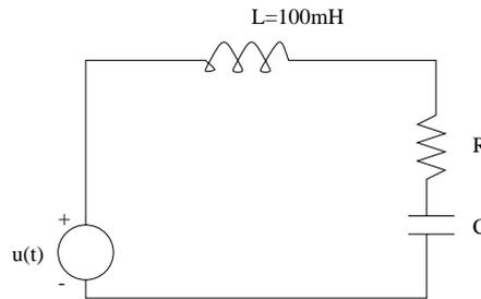
Calculer les valeurs  $R$  et  $C$  pour obtenir une réponse fréquentielle possédant les pôles de la réponse fréquentielle illustrée.
