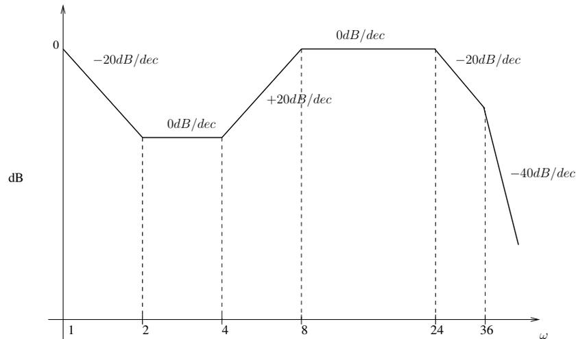
Déterminer les paramètres  $K$ ,  $a$  et  $b$  à partir de ce diagramme.
